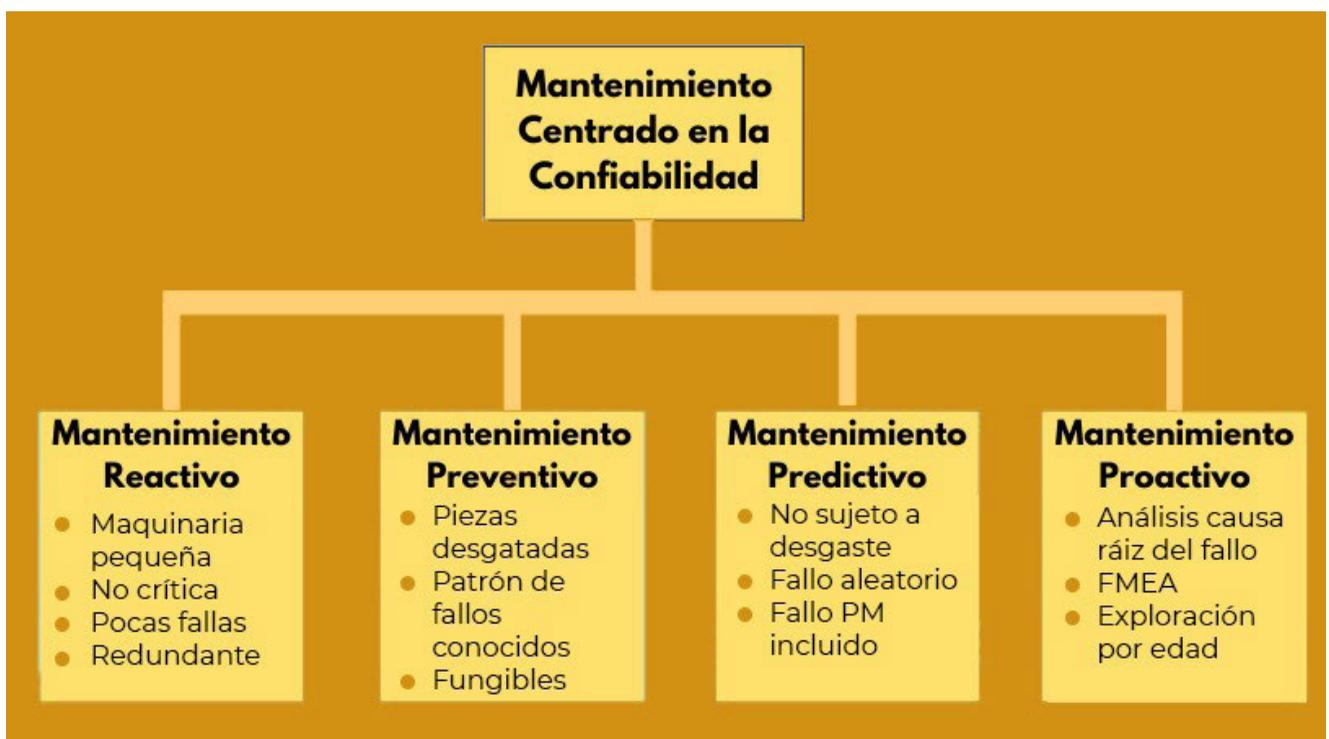
Esquema del flujo de trabajo del Mantenimiento Centrado en la Confiabilidad
