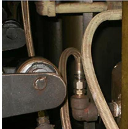
**Longitud insuficiente que favorece la tensión en la manguera durante los pulsos**
