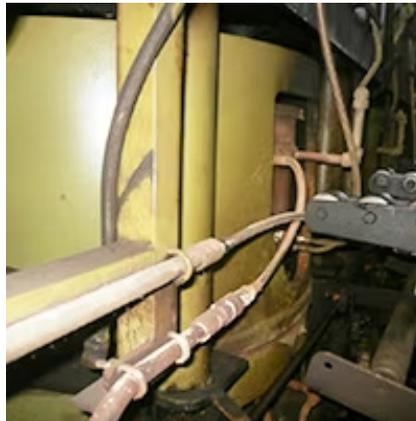
**No utilizar codos y adaptadores para aliviar la tensión en la manguera en conexiones finales horizontales**
