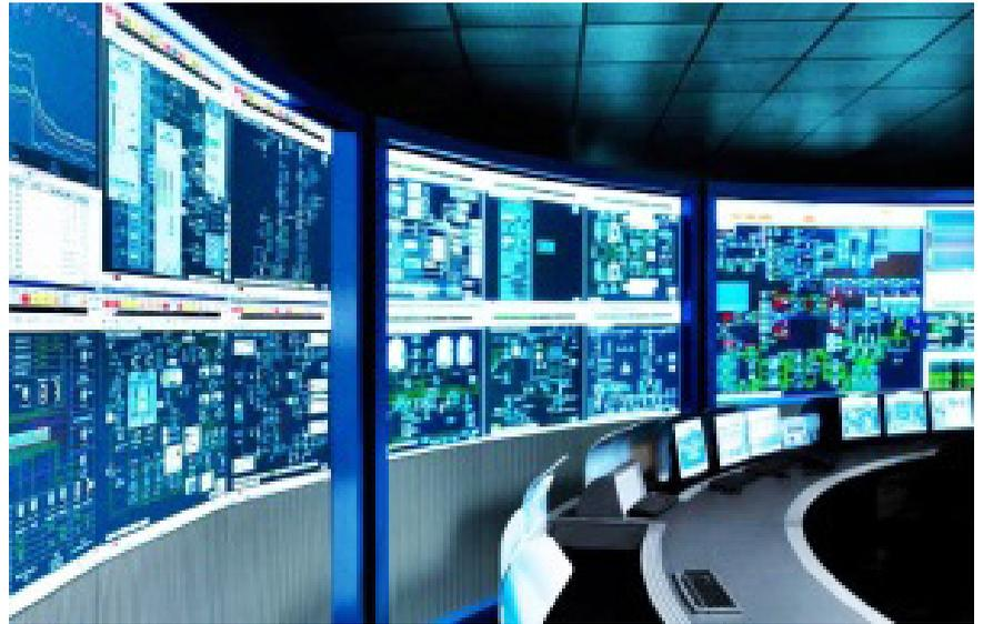
En otro aspecto, SCADA Secured Network es la red que conforma el sistema de que conecta una o varias Unidades Remotas a una Unidad Terminal Maestra (MTU). Por medio de red el personal puede supervisar y controlar un gran número de Unidades Terminales Remotas (RTU). La MTU es a menudo una plataforma informática, como un PC, que ejecuta el Software SCADA.
