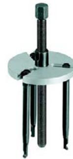
En estos casos no se cuenta con acceso radial o con un anillo exterior ajustado, así que se emplean extractores donde las garras se aferran al borde de la pista de la rodadura del anillo exterior y se apoyan en el anillo interior. El rodamiento debe ser extraído mediante un husillo roscado.
