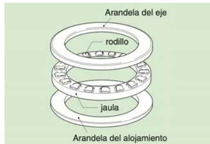
Figura 7. Rodamiento axial de rodillos
