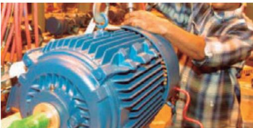
b) Para levantar el motor, use los cáncamos provistos para ello. No use el eje del motor como apoyo para colocar una eslinga o cadena.
