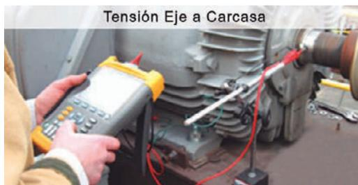
Figura 1. Tensión eje a carcasa
