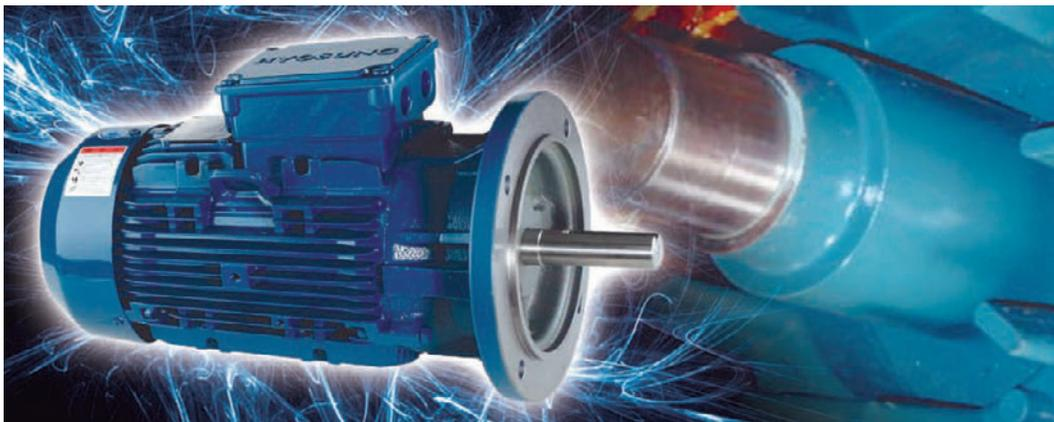
Cuando se alimenta el motor eléctrico con tensión senoidal, 50 ó 60 Hz, se produce una tensión entre el eje y la carcasa. Igual se da en generadores, esto como consecuencia de: asimetrías en el campo magnético, lo cual es inherente al diseño propio de fábrica, cargas electrostáticas por fricción, debido a la rotación, acoples electrostáticos tipo capacitivos
