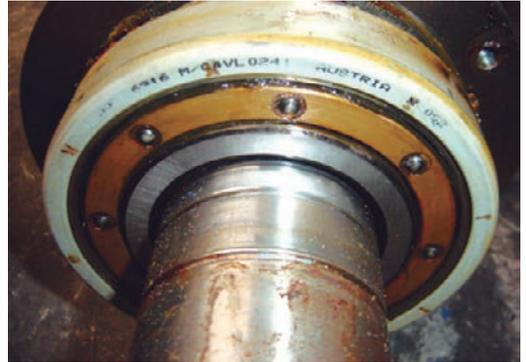
Figura 6. Rodamiento aislado para combatir fenómeno de corrientes en rodamientos.
