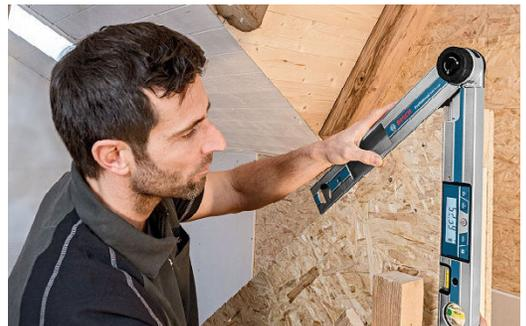
El goniómetro es un aparato que se utiliza para medir ángulos. También es muy utilizado para hacer que un cuerpo gire en un ángulo preciso. Es muy usado en la medición de vidrios y cristales.
