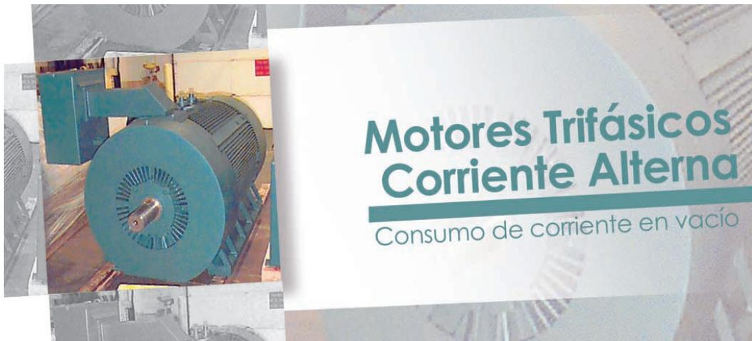
Habitualmente no nos ocupamos del consumo de corriente en vacío (sin carga) cuando se operan motores eléctricos de corriente alterna trifásicos. Lo que más nos interesa es la corriente de arranque o con carga. Ambas son posibles de analizar fácilmente por medio de la placa de características del motor. La corriente en vacío puede ser útil para saber si el motor está bien antes de montarlo en la máquina.
