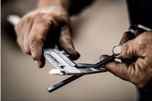
El calibre es un instrumento utilizado para realizar la medición de espesores y de diámetros, tanto interiores como exteriores.
