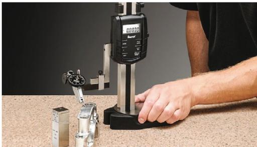
Un calibre de trazado, también conocido como calibrador de altura, es un instrumento que se utiliza en el área del control de calidad. Se encarga de medir y trazar piezas como centros para taladros y ejes de simetría, entre otras.
