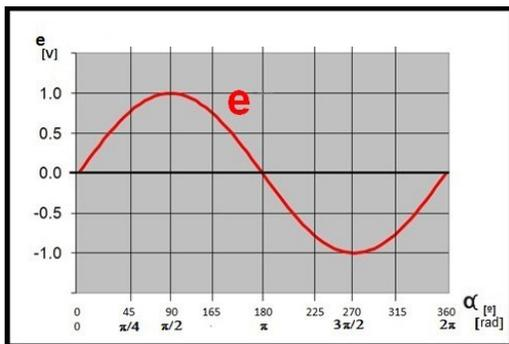
Figura 1- Fuerza electromotriz generada por una bobina
