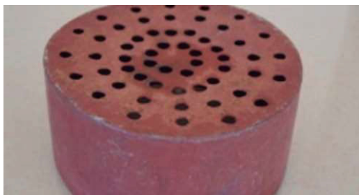
Figura 5. Cubre ventilador mal construido
