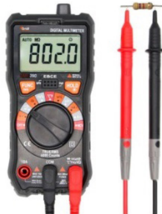
Figura 3. Medición de resistencia con Multímetro GMF-39D
