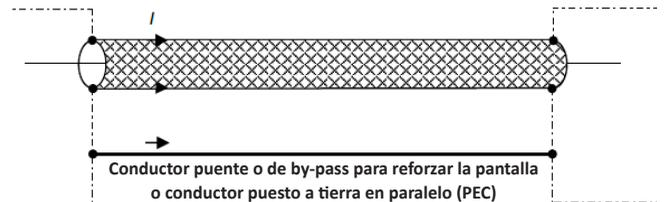
**Figura H.1** - Conductor puente o de by-pass para reforzar la pantalla (conductor puente de interconexión equipotencial o conductor puesto a tierra en paralelo (PEC) para reforzar la pantalla y proporcionar un sistema de interconexión equipotencial común)
