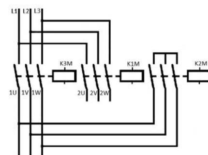
Fig. 2: Conexión de potencia de un motor Dahlander
