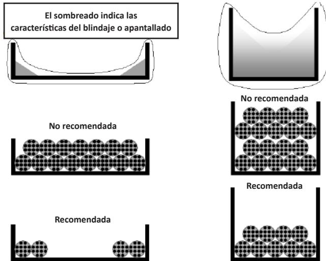
**Figura H.4** - Disposición de los cables en bandejas portacables metálicas y en cablecanales metálicos
