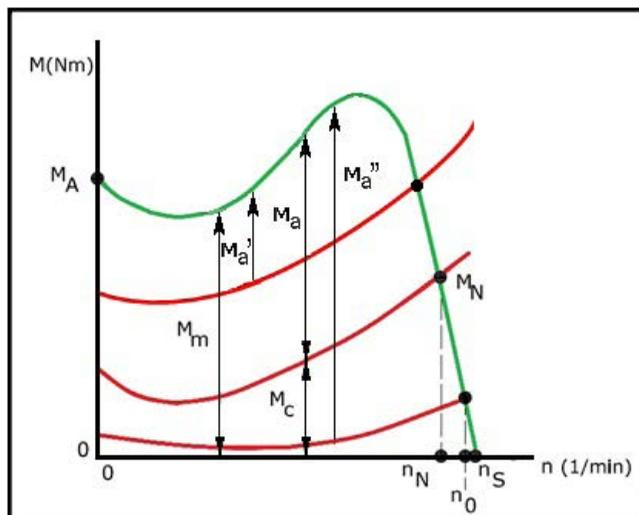
Figura 2. Punto de funcionamiento del motor.
