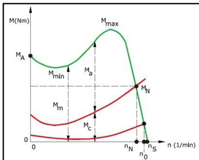
Figura 1. Punto de funcionamiento del motor.
