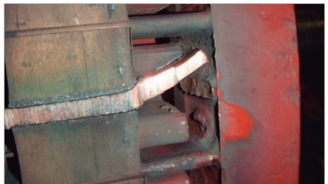
Figura 7. Rotor con una barra rota (Fuente: www.hecoinc.com)
