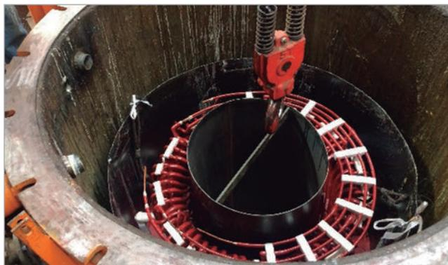
Figura 5. Inicio del proceso de impregnación por VPI.
