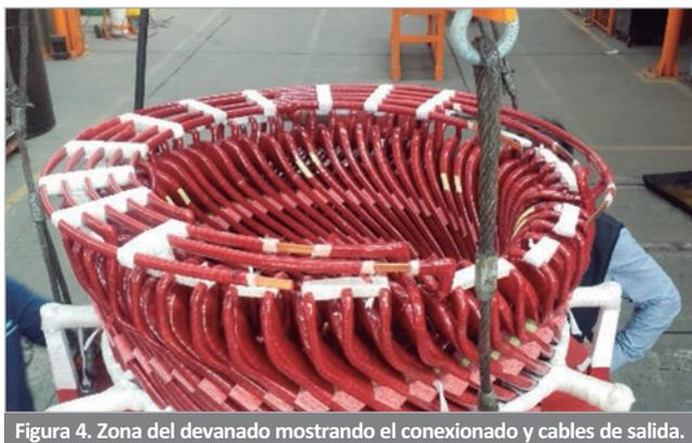
Figura 4. Zona del devanado mostrando el conexionado y cables de salida.
