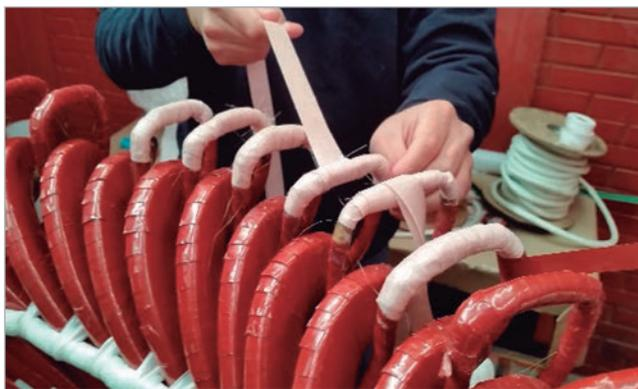
Figura 3. Proceso de rebobinado en motor de 13,8kV.
