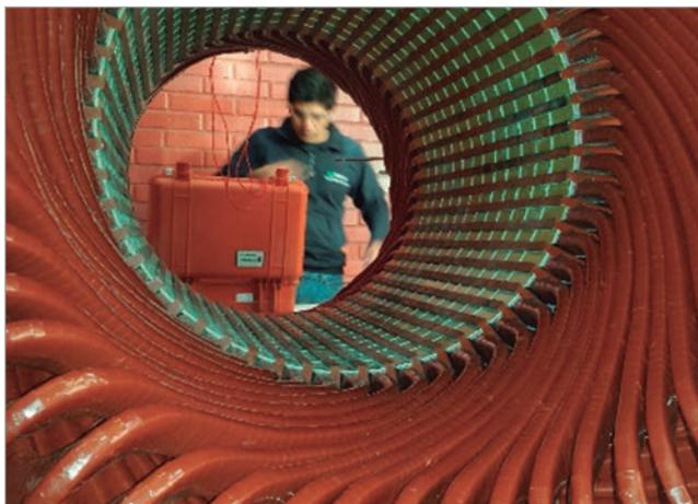
Figura 6. Vista del devanado completo durante ensayos dieléctricos.
