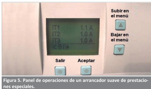
Figura 5. Panel de operaciones de un arrancador suave de prestaciones especiales.
