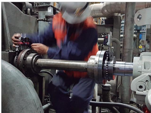
Figura 2. Procedimiento de alineamiento del motor con la máquina de carga (Cortesía de Ferroman S.A.-Chile)
