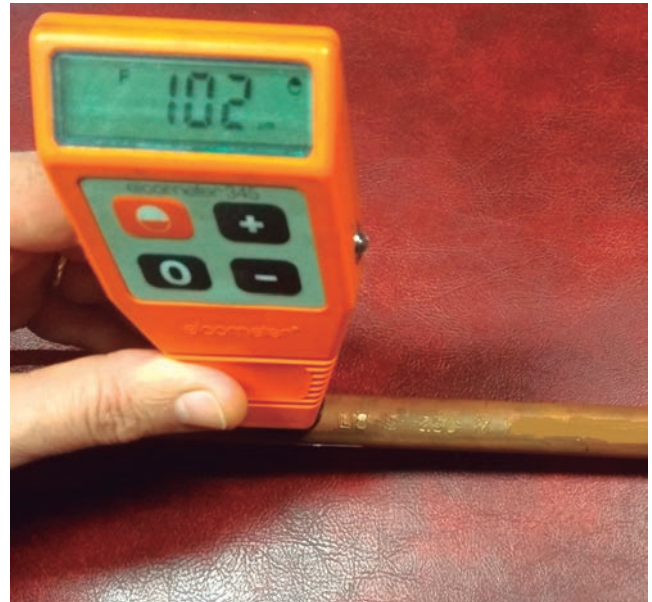
Jabalina marcada que no cumple con la cobertura obligatoria de un mínimo de 250 micrones de cobre.
