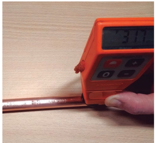
Jabalina marcada que no cumple con la cobertura obligatoria de un mínimo de 250 micrones de cobre.
